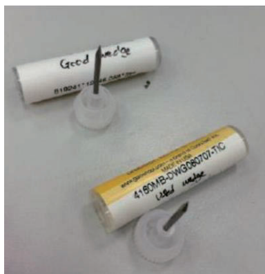
ボンディングツール先端部の差分解析(未使用品と使用済み品との比較評価)
