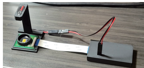
分離型システム（+LED光源） フラットケーブルの長さは300 mmまで対応
